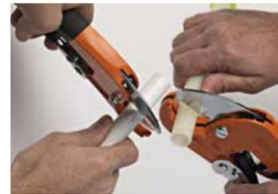
1 Couper le tube perpendiculairement à l'aide d'un coupe-tube.
