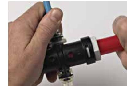
3 Insérez le tube dans le connecteur jusqu'à la fin de la course en vérifiant que le trou
