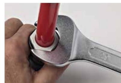
1 Faites tourner la borne à baïonnette dans le sens inverse des aiguilles d'une montre, à l'aide d'une à tubes. (pour 20x2)
