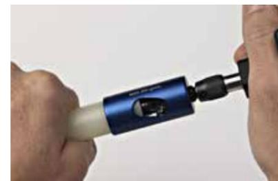
2 Faire un chanfrein avec l'outil de fraisage sur le diamètre extérieur du tube, afin de faciliter l'insertion du tube dans le connecteur et d'éviter tout endom-
